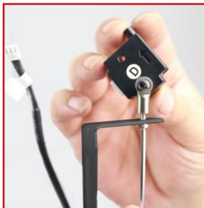
**9.** Instalar el sensor de filamento en la rótula de movimiento con un tornillo M3x8mm y tuerca autobloqueante.
