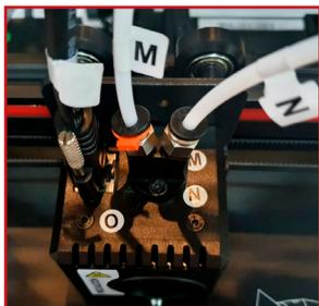
7. Conectar el tubo de teflón del extrusor E2 en el hotend (N).
