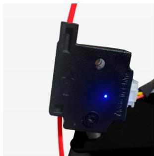
Cuando el sensor detecte que no pasa filamento, se activará una alarma sonora durante unos segundos para avisar la falta del mismo, dejando la impresora en pausa con el pico estacionado evitando así que se generen imperfecciones en la impresión.
