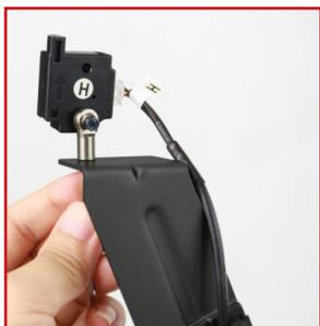
5. Instalar el sensor de filamento en la rótula de movimiento con un tornillo M3 x 8mm y tuerca autobloqueante. Instalar la rótula en el soporte de filamento con un tornillo M3 x 8mm. Conectar el sensor de filamento para extrusor E2 (H). Una vez conectado el cable, asegurar el mismo con los clip de sujeción que se encuentran en el soporte de portarrollos.
