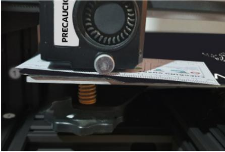
4. Tomar la regla de calibración incluida en Magna 2 y posicionar entre el pico y la cama; ajustar o desajustar el tornillo de calibración que se encuentra debajo de la cama caliente hasta sentir un ligero roce entre el pico y la cama caliente.
