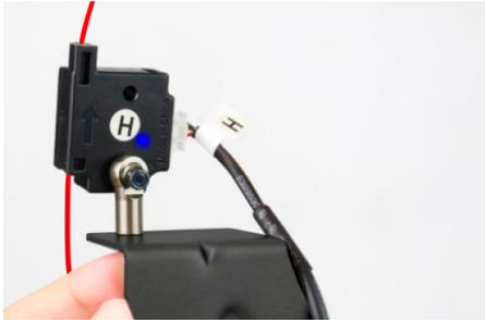
5. Mientras se espera que la temperatura llegue a 210°C, colocar el filamento en el portarrollos y pasar el extremo del mismo a través del sensor de filamento, la luz azul indicará que el mismo ha sido detectado.
