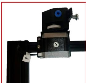
**2.** Conectar el motor del extrusor E2 (J).
