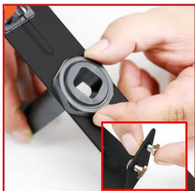
**3.** Instalar el portarrollos. Colocarlo orientado hacia arriba y ajustarlo con la tuerca plástica. Colocar 2 tornillos M3 x 6mm con 2 tuercas T. No ajustar por completo las tuercas T.
