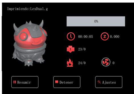
3. Automáticamente la impresora iniciará en la pantalla de impresión en la que se encontraba trabajando previo al corte de energía.
