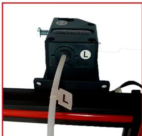
6. Conectar el tubo de teflón en el extrusor E2 (L).
