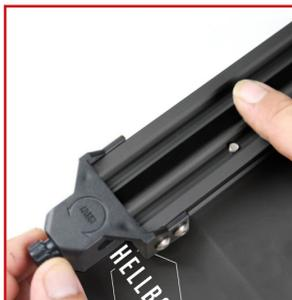
**10.** Ajustar la tensión de la correa del eje Y. Girar la perilla en sentido horario hasta tener una tensión apropiada.
