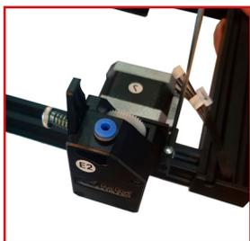
**1.** Tomar el extrusor E2. Instalar con tornillos M4 y ajustar en la parte superior derecha del marco de aluminio.
