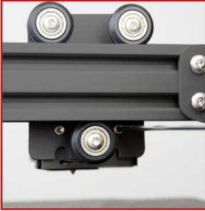
5. Verificar que el cabezal de impresión esté colocado correctamente moviéndolo cuidadosamente. Si el mismo tiene juego ajustar nuevamente los tornillos M3x6mm.
