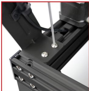
4. Instalar el soporte de portarrollos en la base de aluminio y ajustarlo con las tuercas T. Asegurarse de que la tuerca T esté correctamente ajustada en la ranura del marco de aluminio.
