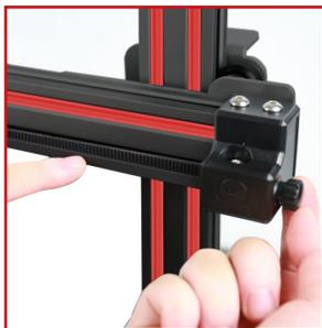
**11.** Ajustar la tensión de la correa del eje X. Girar la perilla en sentido horario hasta tener una tensión apropiada.
