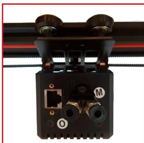
**4.** Instalar el cabezal de impresión al carro de movimiento con 2 tornillos M3 x 6mm y ajustalo con la llave allen de 2,5mm.
